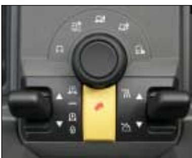
Уникалната система Terrain Response адаптира ходовата част на автомобила към различните условия на пътя
