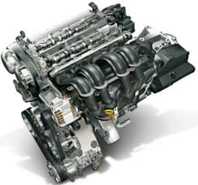
широката гама от бензинови двигатели на фамилията Focus, която включва 16-клапанови двигатели с работен обем и мощност: 1.4 л/80 к.с., 1.6 л/100 к.с. и 2.0 л/145 к.с. Независимото управление на гвата разпределителни вала (Ti-VCT) подобрява въздушния поток през двигателя и предоставя повече въртящ момент, като същевременно намалява средния разход на гориво с до 5 процента.
